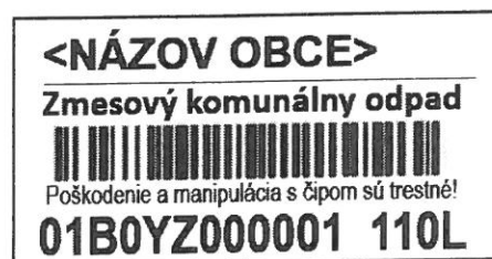
Etiketa čipu má rozmery 32 mm x 16 mm
